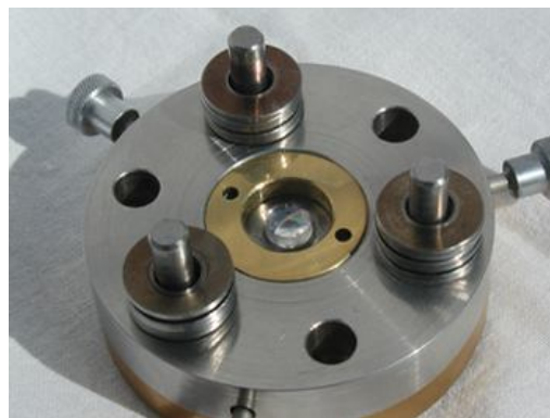
Рис. 1. Камера высокого давления с сапфировыми наковальнями ( P=10 ГПа, \epsilon=10^4 Вт/см 2 ).
