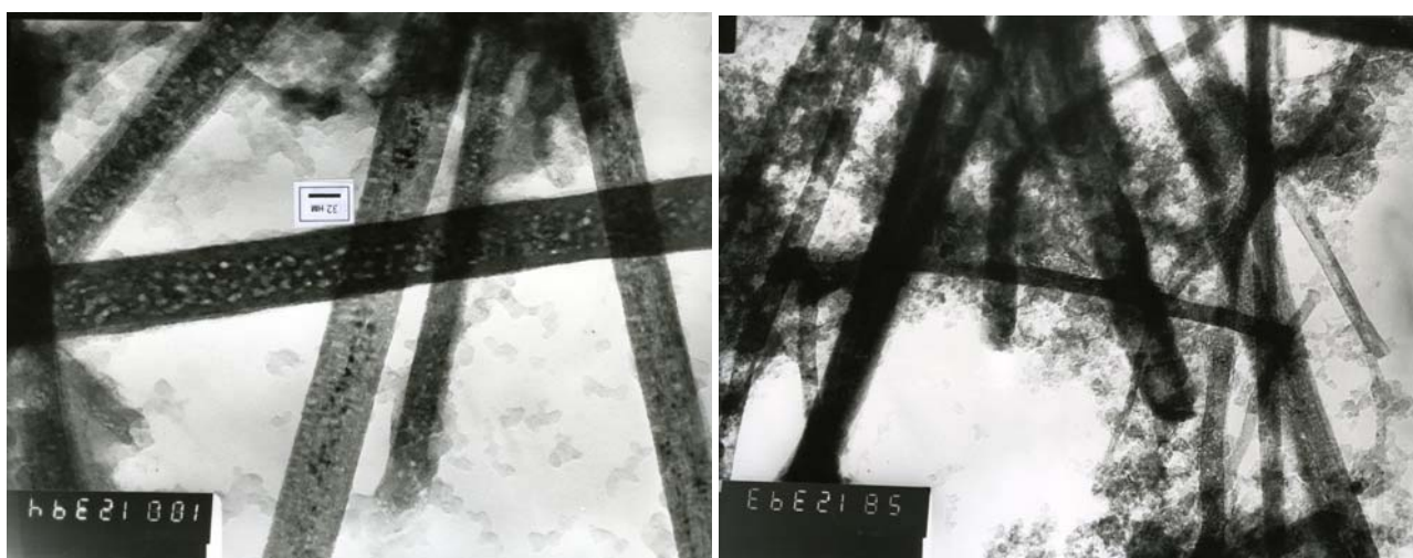
Рис. 3. Углеродные нанотрубки, заполненные хлорсодержащим соединением (получены в дихлорэтано).
