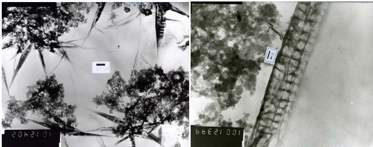
Рис. 2. Углеродные наноструктуры, полученные в \text{CCl}_4 .
