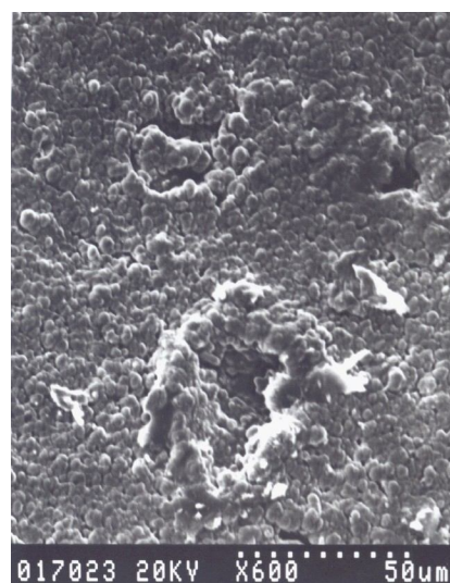
Фото 1. Микрофотография покрытия из никеля, метод нанесения – МИР.
