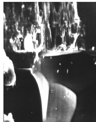
Рис. 2 Электронно - микроскопическое изображения скола однослойной пленки твердого электролита на основе диоксида циркония.
